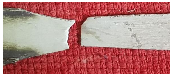
Рис. 9 – Фрагмент робочої частини зразку після руйнування
