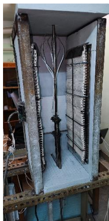
Рис.1 — Експериментальна установка. Момент монтажу зразку перед встановленням останньої стінки печі
