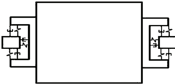
Рисунок 4 – Схемы взаимодействия: а – Расчетная схема взаимодействия сосуда с проводниками; б – Схема кинематического взаимодействия систем «башмак-направляющие» с коробчатыми проводниками; в – Схема взаимодействия скипа с искривленным участком проводников, I – проектное положение сосуда, II – фактическое положение сосуда на участке ствола с искривленными проводниками; г – Твердотельная модель системы «сосуд-армировка» в SolidWorks-SolidMotion
