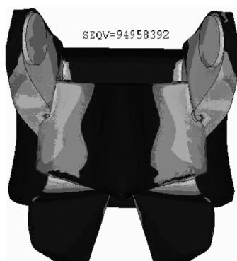
Рисунок 10 – Напряженное состояние модели с протезом, контактная задача
