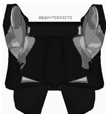
Рисунок 9 – Напряженное состояние модели с протезом без учета контакта
