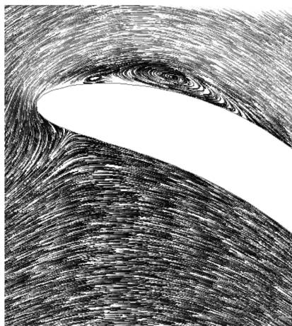
Рис. 4. Течение в области отрыва
