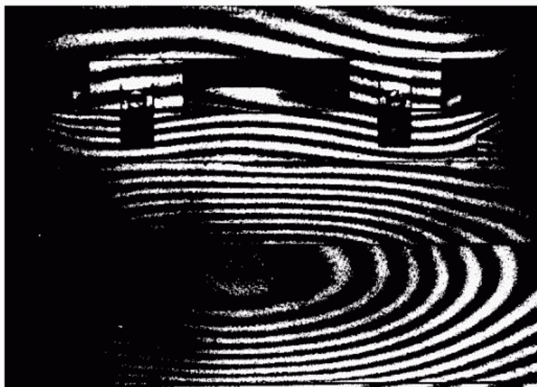
Рис. 5. Фрагмент спекл-интерферограммы блока пресс-формы
