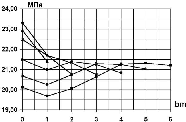
Рисунок 3 – Максимальные напряжения на растянутой стороне зубьев прямозубых колес  $z = 20$ ;  $\alpha = 20^0$ ;  $\xi = 0$
