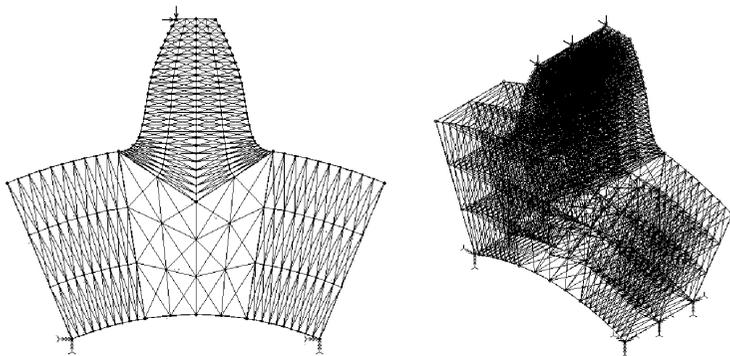
Рисунок 1 – Конечно-элементная модель эвольвентного прямозубого колеса в плоском и объемном виде без отверстия.
