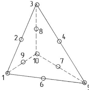
Рисунок 2 – Тетраэдральный 10-ти узловой конечный элемент.
