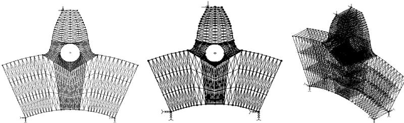
Рисунок 4 – Конечно-элементная модель прямозубого колеса в плоском и объемном виде с отверстием  $d_{\text{ОТВ}} = m$ , и с центром на  $H = d_{\text{ВП}} = 0,0175 m$ , и  $H = d_{\text{ВП}} - 0,25m$ , при  $z = 20$ ;  $\alpha = 20^\circ$ ;  $\zeta = 0$
