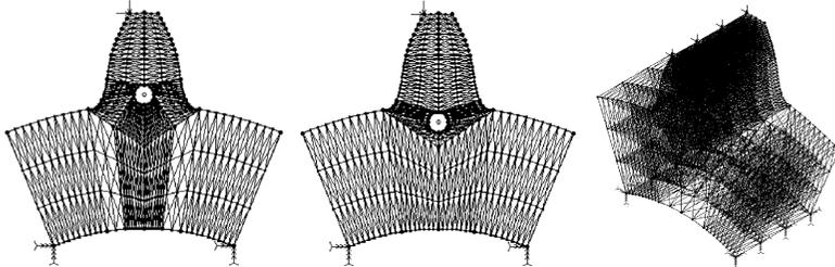
Рисунок 5 – Конечно-элементная модель прямозубого колеса в плоском и объемном виде с отверстием  $d_{\text{ОТВ}} = 0,5m$ , и с центром на  $H = d_{\text{ВП}} = 0,25m$ , и  $H = d_{\text{ВП}} - 0,4m$ , при  $z = 20$ ;  $\alpha = 20^\circ$ ;  $\zeta = 0$
