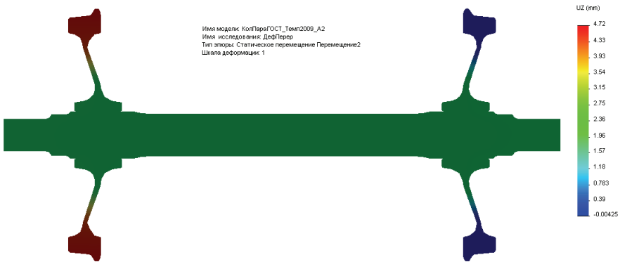
Рисунок 7 – Деформация колесной пары в осевом направлении в момент базирования
