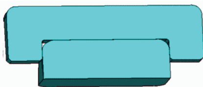
Рисунок 6 – Геометрическая модель сектора роликового подшипника с внешним кольцом
