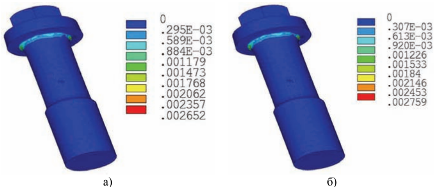
Рисунок 7 – Пластические деформации в болте: а) 1-я модель, б) 2-я модель
