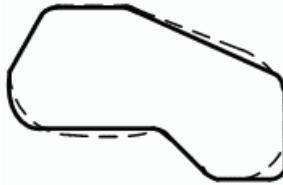
Рисунок 10 – Контур исходного и нового отверстия ребра
