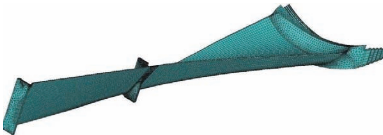
Рисунок 2 – Конечно-элементная модель лопатки
