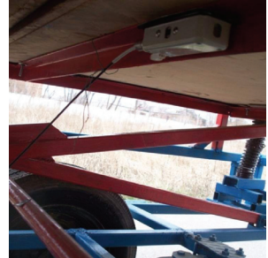
Рисунок 5 – Розміщення датчику вібрацій
