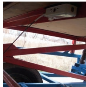
Рисунок 5 – Розміщення датчику вібрацій
