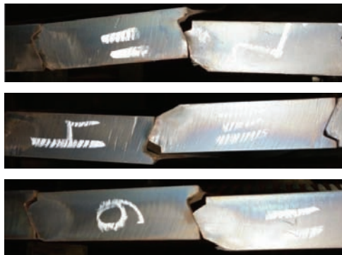
Рисунок 1 – Вид поврежденных разъемных соединений лопаточного аппарата 4-й ступени паровой турбины после трех лет эксплуатации (результат температурной перегрузки)
