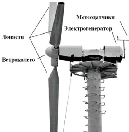
Рисунок 1 – Ветрогенератор ВЭУ-20М
