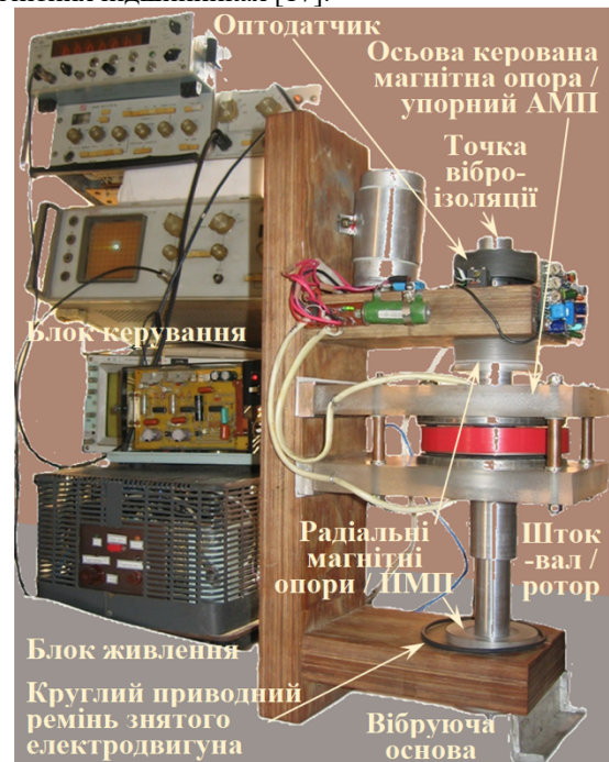
Рис. 8 – Лабораторно-експериментальна установка віброгасної та віброізолюючої комплексної пасивно-активної магнітної опори
