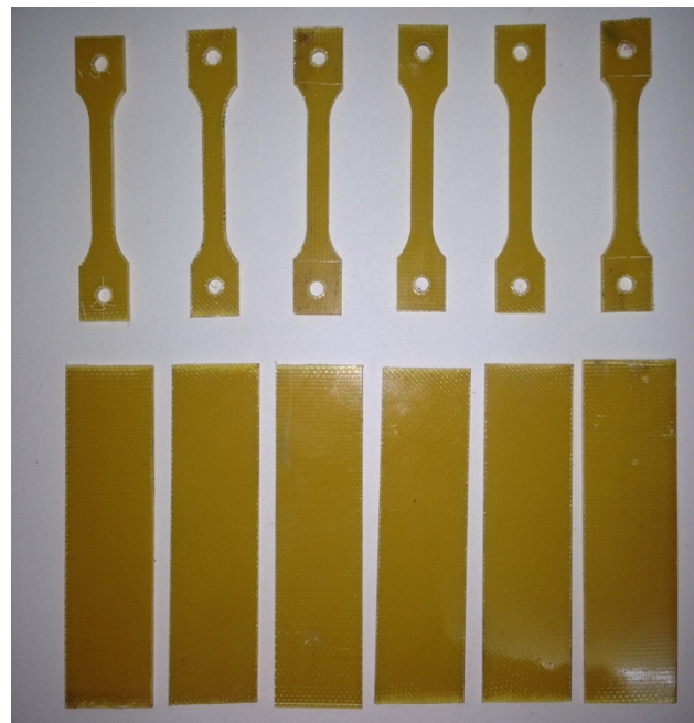
Рис. 8 – Вирізані під різними кутами композиційні зразки
