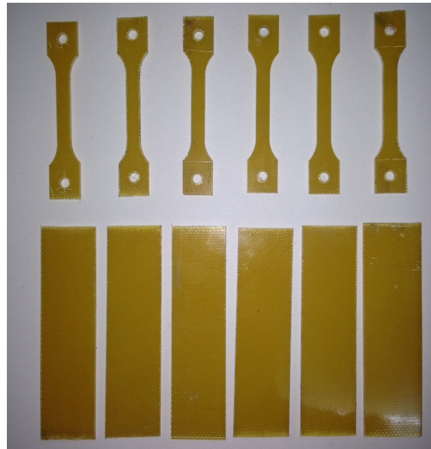
Рис. 8 – Вирізані під різними кутами композиційні зразки
