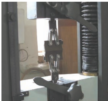
Рисунок 3 – Испытание на растяжение образцов из двух элементов
